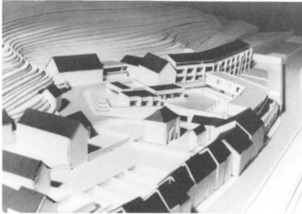
*Fig. 164. Maquette. A droite, l'alignement des maisons rue Fétis et leurs jardins. En haut, à gauche, un groupe de trois bâtiments d'implantation orthogonale subsiste. Deux géométries à mettre en accord.*
