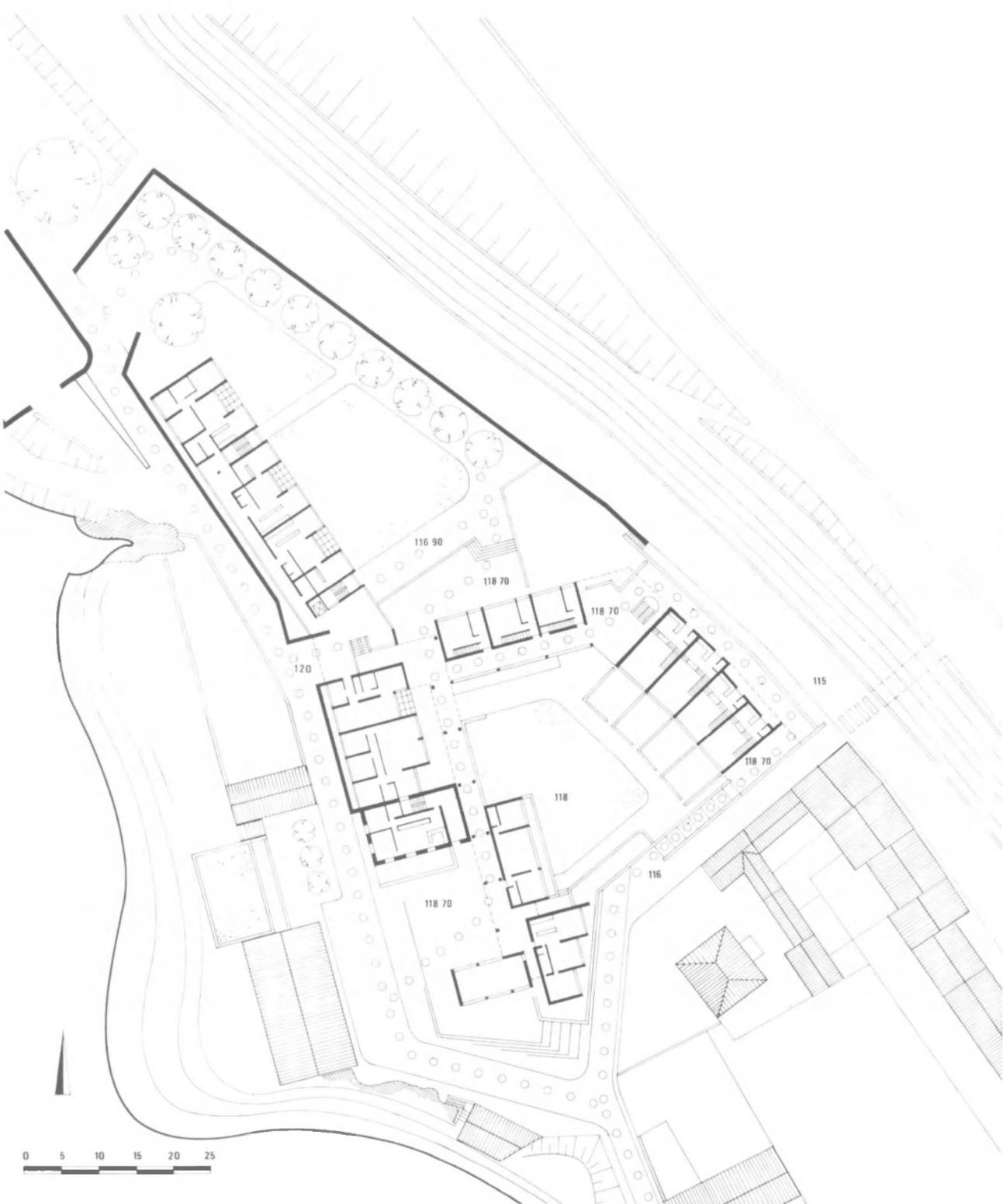
Fig. 162. Plan du rez-de-chaussée. Venant du centre du village, une place d'accueil au niveau 118,70 m, entourée d'habitations, d'une superette et peut-être d'un café, mène à couvert aux habitations. Les fortes déclivités du terrain et les protections d'une sécurité indispensable aux piétons imposaient une infrastructure d'accès.
