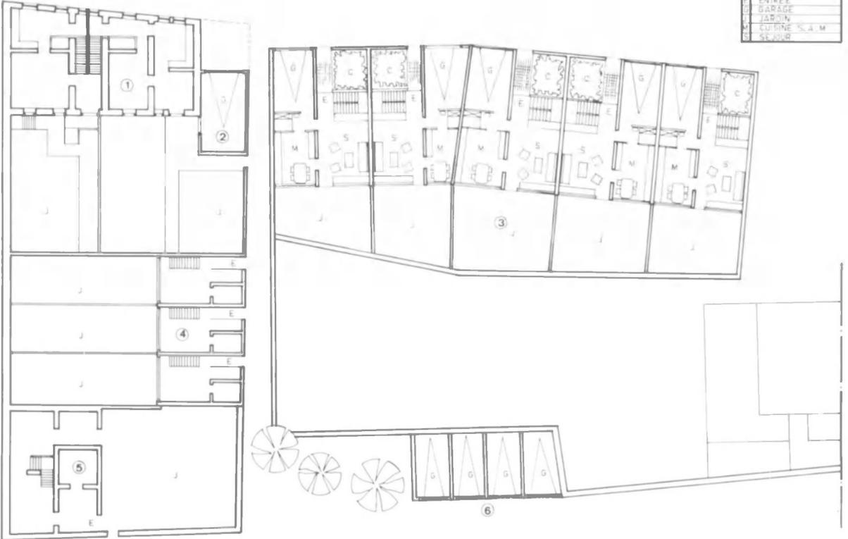
Fig. 159 et 160. R. Bastin : îlot 4. Plan de rénovation conservant les immeubles 1 et 5, de valeur architecturale et plan terrier des maisons, dont le groupe composé de cinq logements de 7 m en façade.
