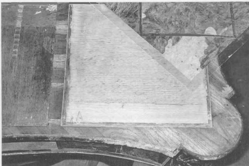
Fig. 7. Incrustation du triplex en chêne de 2,4 cm juste avant la repose de la marqueterie, déjà sous plexiglas.
